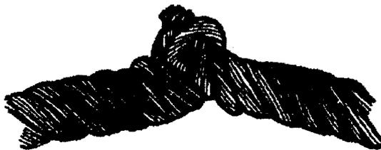
Рисунок 15. Перекручивание каната.
